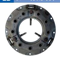
レバータイプで プレッシャープレ ートとカバーが(ストラッププレート を介さず)直接 噛み合い、固定 されているタイ プです。
