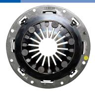
ダイヤフラムタ イプで、プレッシャープレートとカ バーが(ストラッ ププレートを介さず)直接噛み合い、固定されているタイプです。
