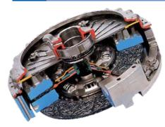
プレッシャープレートに似た中間プレートを挟み、フライホイール側とトランスミッション側に別々のクラッチディスクを使用するタイプです。
